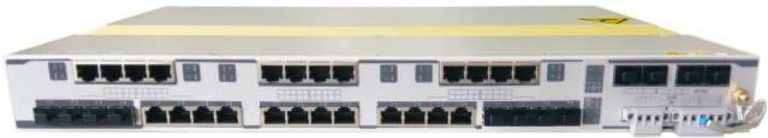
华信傲天 IS2000 系列增强型模块化工业以太网交换机提供多插槽的机体，以及多种集成式，包括千兆位网络、内容交换，所有模块支持在线升级功能。IS2000 系列增强型模块化工业交换机使用统一的光模块和操作系统软件，形成了能够适应未来发展的体系结构，由于能提供操作一致性，因而能提高设备的利用率。其基于硬件的算法可确保每个节点的自愈时间小于 5 毫秒，环网自愈时间小于 50 毫秒（典型值）。IS2000 系列增强型模块化工业交换机采用 FPGA 和 CPLD 动态重构及重复编程技术，具有高稳定性和高可靠性，并可对各种关键运行参数进行本地及远程监控。IS2000 系列增强型模块化工业交换机采用独特的扩展工业级设计与工艺，适合于各种恶劣环境及野外应用。
