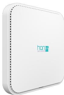
AP502最大支持约3.570Gbps峰值速率(5GHz 2.88Gbps, 2.4GHz 688Mbps)，UL/DL MU-MIMO。支持2.5GE上行接口。
